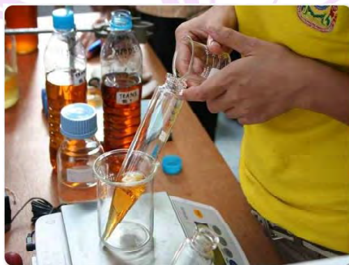
การวิเคราะห์คุณภาพไบโอดีเซลอย่างง่ายด้วยไมโครเวฟ
