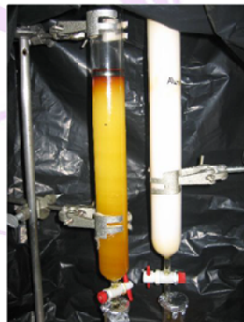
การแยกสารแคโรทีนและโทโคฟีรอลออกจากน้ำมันปาล์มดิบ
