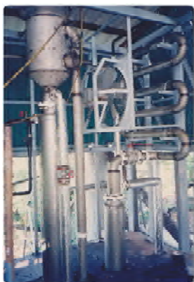
กระบวนการกลั่นน้ำมันปาล์มแบบต่อเนื่องด้วยเทคโนโลยีฟิล์มบาง (Thin Film Technology)
