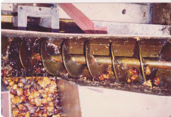
การปรับปรุงโรงงานสกัดน้ำมันปาล์มทดสอบ ที่สหกรณ์นิคมอ่าวลึก จำกัด จังหวัดกระบี่ โดยใช้รางเกลียวทอดผลปาล์ม และใช้ไม้พินเป็นเชื้อเพลิงแทนก๊าซ LPG
