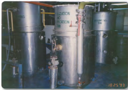
ถังกลั่นน้ำมันปาล์มบริสุทธิ์แบบกะ ขนาด ๒,๐๐๐ ลิตร
