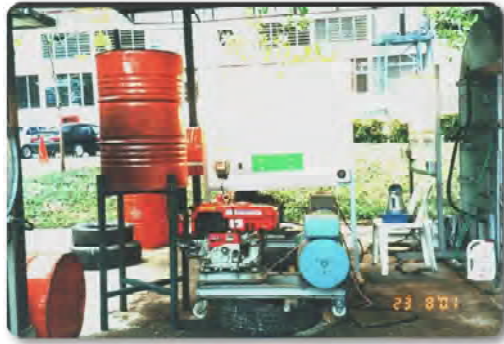
การทดสอบเครื่องย่นการเกษตรโดยใช้น้ำมันปาล์มดิบ น้ำมันปาล์มกลั่นบริสุทธิ์ และเมทิลเอสเทอร์
