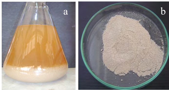
ลักษณะพอลิเมอร์จากน้ำนึ่งปาล์มหลังจากการตกตะกอนด้วย 95% เอทานอล (a) และหลังจากการทำแห้งแบบแช่เยือกแข็ง (b)
